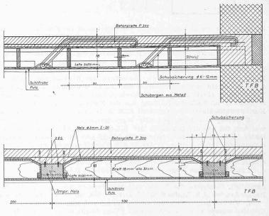
Schubsichere Verbindung zwischen Beton und Holz. — Masstab 1:15
