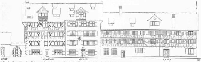
Abb. 6. Fassaden der Häuserreihe Bärengasse Nr. 22 bis 18, renoviert durch Müller & FREYTAG, Arch., Zürich. — 1:300
