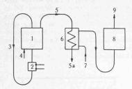
Abb. 1. Schema des elektr. Brown Boveri Grastrockners mit Wärmerückgewinnung
