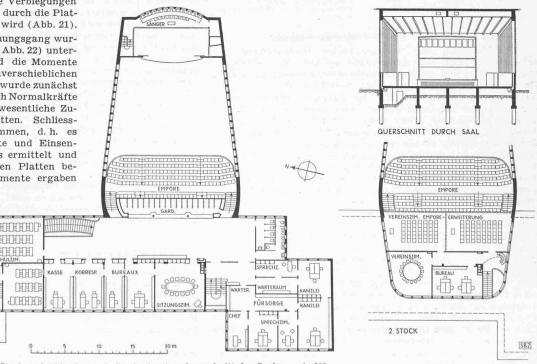
Abb. 14. Grundriss vom 1. Stock und Abb. 15 vom 2. Stock, darüber Querschnitt des Saales. -1:500
