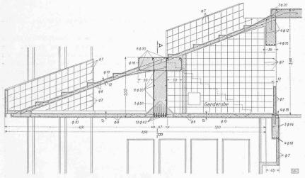
Abb. 19. Armierungsplan der über den T-Träger vorkragenden Empore. -1:80
