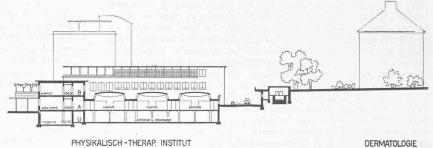
Abb. 16. Schnitt durch den Flachbau des Physikalisch-Therapeutischen Instituts. — 1:800
