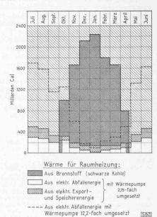
Abb. 4. Monatlicher Wärmebedarf der Schweiz für Raumheizung und für Heizzwecke verfügbare Abfall-, Export- und Speicherenergie. Links ohne, rechts mit Wärmepumpe
