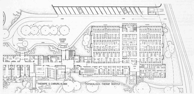
Abb. 15. Oestliches Ende des Bettenhauses Ost, Geschoss A, rechts die Gloriastrasse, Zugang zum Hörsaalflügel und Einlieferung in links: Spezialabteilung (Absonderung, vgl. Abb. 4, S. 255); rechts davon in das Physikalisch-Therapeutische Institut Masstab 1:800
