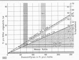
Abb. 6. Warmwasserheizung nach D. 3000 Vollbetriebstunden pro Jahr. Strompreis 3 bzw. 5 Rp./kWh
