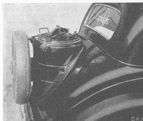
Abb. 3. Azetylen-Generator nach dem Tauchsystem EXCELSIOR
