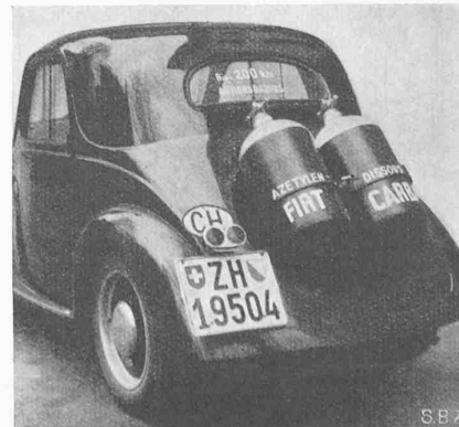
Abb. 11. Azetylen-Dissous CARBA (auf Topolino)
