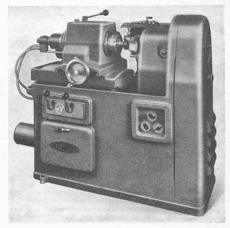
Abb. 2. Innengewinde-Schleifmaschine Reishauer Typ RI
