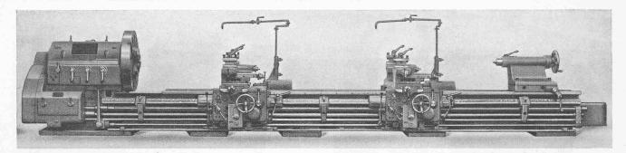
Abb. 1. Grösste Drehbank der Werkzeugmaschinenfabrik OERLIKON, Bührle & Cie., Modell DM5a, mit 8000 mm Spitzenweite
