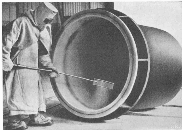
Abb. 3. Pudern eines Kessels mit hochsäurefestem Email
