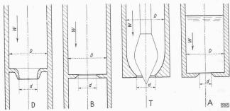
Vergleich verschiedener Durchfluss- und Ausfluss-Oeffnungen D Normdüse, B Normblende, T Freistrahldüse, A Bodenöffnung
