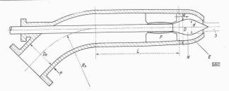
Abb. 1. Schematische Skizze des Einlaufkrümmers einer Freistrahlturbine
