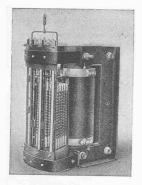
Abb. 20. Wechselstrom-Regler Bordoni, mit 4 Schlitten
