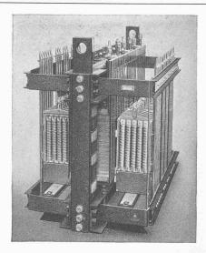
Abb. 22. Bühnen-Wechselstromregler System Bordoni mit 54 Regelschlitten
