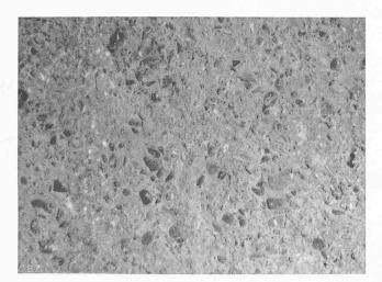
Abb. 7. Aufgerauhter Beton P 250, trocken abgebürstet
