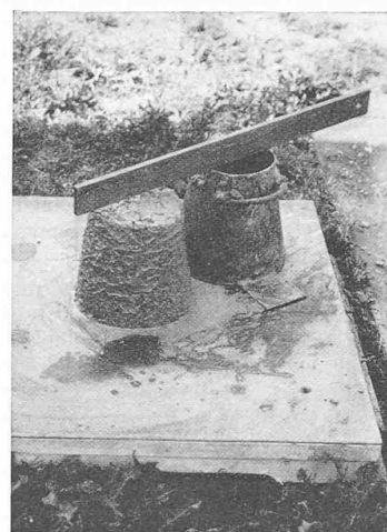
Abb. 3. Setzmass (1 bis 1,5 cm) von Beton P 250
