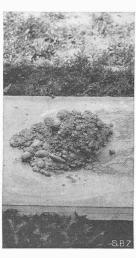
Abb. 4. Ausbreitmass (25 bis 30 cm), Wasserzusatz 6,8 Gewicht-0/0
