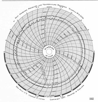
Abb. 3. Tagesdiagramm des Kessel-Enddruckes (äussere Kurve in lbs./sq. in.) u. Temperatur am Ueberhitzer-Austritt (innere Kurve in  $^0\mathrm{F}$ )
