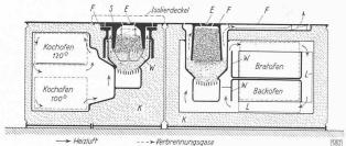
Abb. 22. Schematischer Schnitt 1:30 des AGA-Herdes W Wärmeleitrippen, E Kieselgur-Isolierung, E Wärmeleit-Lamellen, E Einfüllöffnungen, E Schnelkochplatte (400 °C), E Fortkochplatten 250 bis 100 °C
