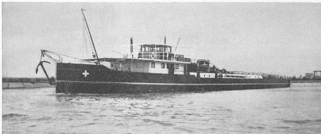
Abb. 4. Dreischrauben-Sulzerdieselschlepper «Zürich», 2400 PS, der Schweiz. Reederei A.-G. Schleppt 2500 t nach Basel
