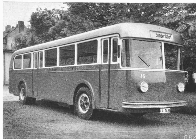
Abb. 5. Dieselelektrischer Heckmotor-Autobus der Stadt Luzern
