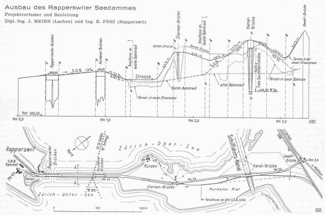
Abb. 1. Plan 1:20000. — Abb. 2. Längenprofil, Längen 1:20000, Höhen 1:400
