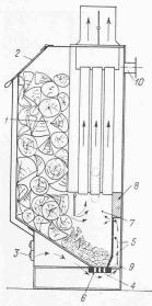
Abb. 3. Zentralheizungskessel mit angebautem Bunker (1) und niedriger Brennschicht. 2 Fülltür, 3 Luftzufuhr, 4 Primär-, 5 Sekundärluft, 6 bewegl. Rost, 7 grosser Verbrennungsraum, 8 Schamotte, 9 Heizungs-Rücklauf, 10 -Vorlauf
