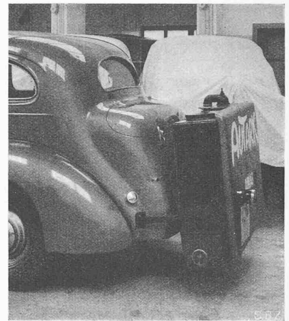
Abb. 8. Holzkohlengas-Generator AUTARK Anbau hinten an einen Personenwagen
