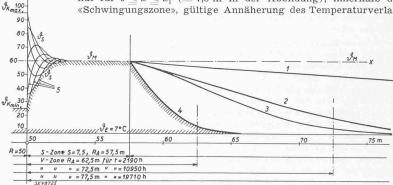
Temperaturverlauf in der S- und V-Zone. x Axe der Temperaturschwingungen in der S-Zone. 1  $\vartheta v$ , Stationär,  $t=\infty$ . 2  $\vartheta v$ , t=19710 h (2. Betriebsperiode). 3  $\vartheta v$ , t=10950 h (1. Betriebsperiode). 4  $\vartheta v$ , t=2190 h (Anheizen), 5 Zeitliche Verschiebung je  $^{1}/_{8}$  T=1095 h.
