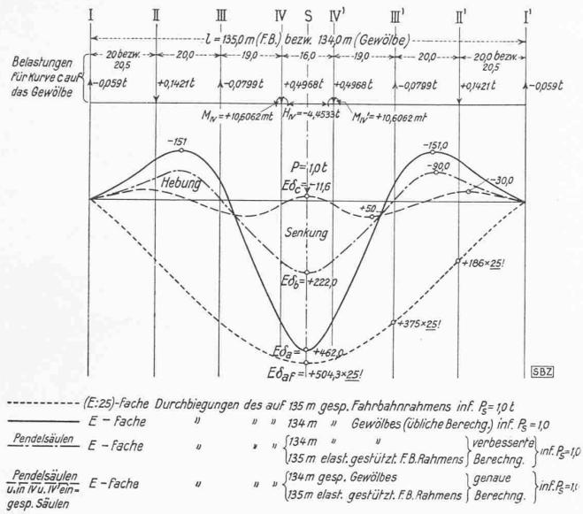
Die Ergebnisse der Kräzernbrücke waren somit eine Ueberraschung, da es sich um eine Brücke der II. Gruppe handelt, in die alle neueren und über 130 m weit gespannten Brücken sich einreihen lassen. Für solche Brücken werden sich in Zukunft diese umfangreichen Berechnungen kaum vermeiden lassen, es sei denn, dass man auf Kosten der Vertikalsteifigkeit die Brückenkonstruktion weitgehend ihres monolithischen Charakters beraubt, wie bei dem Bogen der Aarebrücke der Lorrainehaldelinie der SBB in Bern.
