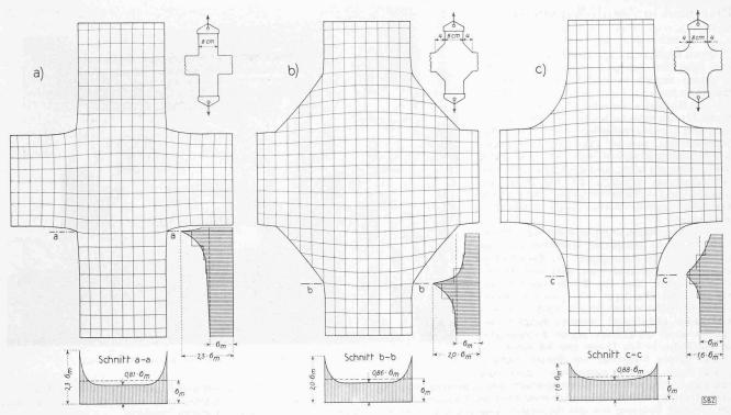
Abb. 4. Spannungsverlauf in Kreuzknoten an Gummimodellen gemessen. Die Modellaufnahmen (Netzlinien) sind photographische Negative, zum Zweck der Reproduktion gepaust und hier in  $^{3}/_{10}$  natürlicher Grösse wiedergegeben
