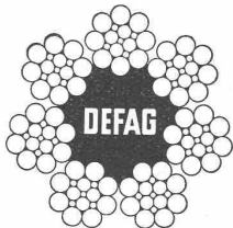
drallarme und spannungs- freie Normal-Litzen- Konstruktion
