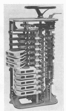
Abb. 12. Steuerkontroller, Funkenkamine aufgeklappt und herausgezogen
