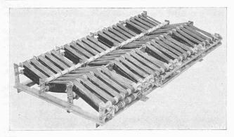
Abb. 14. Fahr- und Bremswiderstände aus Chrom-Nickelband
