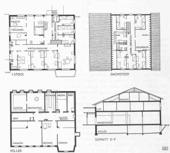
Abb. 2. Grundrisse und Schnitt vom Hauptbau. — 1:500
