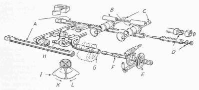
Abb. 12. Schema der Einspritzmengen-Verstellung am Junkers Flugmotor, Typ 211 A Hauptzahnstangen, B federbelastete Zahnstangenstücke, C Pumpenstempel, D Einzelregulierung der Pumpenelemente. E Reglerdose, F Drehschieberventil des Servomotors, G Servomotor, H Zahnsegment, I Diagramm des Plattenkolben-Servomotors, K Bewegungsrichtung des Plattenkolbens zur Anreicherung des Gemischs, L Bewegungsrichtung des Plattenkolbens zur Magerung des Gemischs
