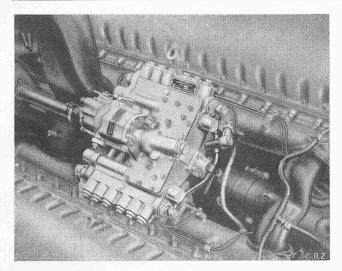
Abb. 7. Benzin-Einspritzpumpe am Junkers Flugmotor, Ansicht von unten
