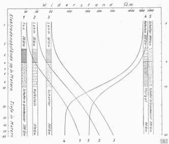
Abb. 1. Geoelektr. Sondierung, Zweischichtenproblem, Schichtgrenze 4 m
