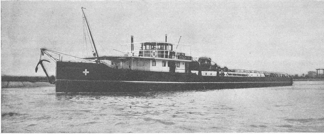
Dreischrauben-Sulzer-Dieselschlepper «Zürich» von 2400 PS e der Schweiz. Reederei A. G., Basel. Länge 65 m, Breite 8 m
