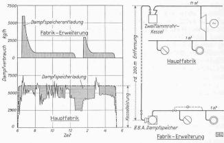
Abb. 6. Dampfspeicherung für Erweiterung einer Teppichfabrik
