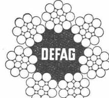
drallarme und spannungs-freie Normal-Litzen-Konstruktion
