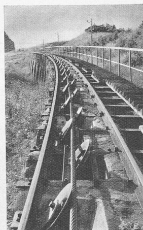
Abb. 6. In einer Minimalkurve Oberbau der Giesserei Bern, v. Rolsche Eisenwerke
