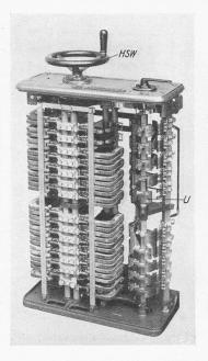
Abb. 17. Kontroller für Handbetrieb *HSW* Handrad-Schaltwalze, *U* Umschaltwalze
