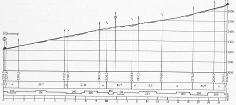
Abb. 5. II. Sektion : Hektometer, Radien, Neigungen in 0/0, Meereshöhen (nicht überhöhtes Profil)
