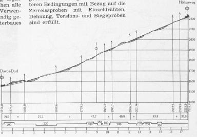
Abb. 4. I. Sektion: Hektometer, Radien, Neigungen in  $^0/_0$  (nicht überhöht)
