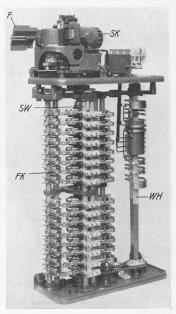
Abb. 18. Automatischer Kontroller SK Servomotor, F Flügelhemmung, SW Schaltwalze, FK Feste Kontakte, WH Walze für Hilfstromkreise
