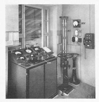
Abb. 21. Führerstand I. Sektion. — A Amp., V Voltmeter, T Tachometer, WS u. WA Wagenstellungsanzeiger, SL Signal-lampe für Oelschalter, H Handbremse, HO Handantrieb des Oelschalters, WM Windmesser (vgl. ferner Legende zu Abb. 19)
