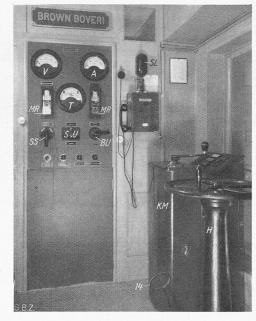
Abb. 23. Schaltgerüst für automat. Betrieb II. Sektion Abb. 22. Führerstand der II. Sektion G Gleichrichter, SO Oelpumpe-Schütz, ES Einfahrtüberwachung-Schütz, HS Hilfschütz, T Tachometer, A Amp., V Voltmeter, SR Steuer, Hilfs-, Brems- u. Oelschalter-Relais, SU Stations-Umschalter, BU Betriebs-Umschalter, SS Steuerschalter, SL Signallampe für Oelschalter, KM Hand-Kontroller, H Handbremse (vgl. ferner Legende zu Abb. 19)
