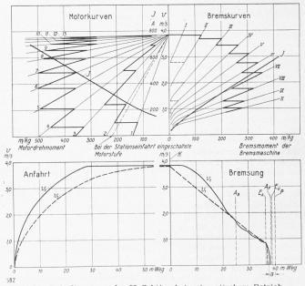
Abb. 20. Fahrdiagramm der II. Sektion bei automatischem Betrieb Legende: a mittl. Abstand zwischen Wagen- u. Stationspuffer 2,54 m, As bewegl. Anschlaghebel. Ea Abschaltung durch Endausschalter, AF fester Anschlaghebel, Eu Endumschalter, P Pufferbalken, K Kontakt am Wagenstandanzeiger,  $v_1$  Fahrgeschwindigkeit bei Anfahrt und Bremsung mit max. Ueberlast bergwärts,  $v_2$  desgl. talwärts
