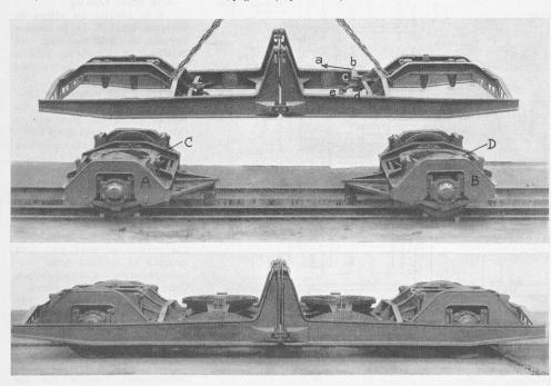
Fig. 7. Bogie porteur médian, décomposé et assemblé, constr. Société Industrielle Suisse Neuhausen
