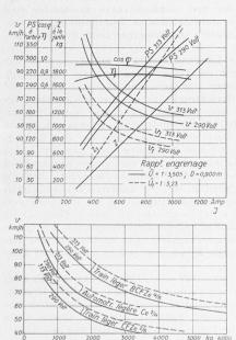
Fig. 11. Caractéristiques des moteurs, courbes vitesse-effort de traction
