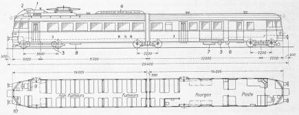
Fig. 3. Train léger CFZe 2/6 681 du BSB. 1:250. — 101 places assises, 39 pl. debout. Poids en service 42,8 t. 1 Transf. à gradins, 2 Contact. méc.-pn. de graduation, 3 Moteur de traction, 4 Résistances de freinage, 5 Moteur-compresseur, 6 Moteur-génératrice, 7 Batterie d'accumulateurs, 8 Shunt pr. mot. de traction, 9 Tableau de distribution, 10 Coupleur-inverseur
