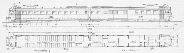
Fig. 1. Croquis d'encombrement du train léger BCFZe 4/6 BLS/BN — 1:250. — 139 places assises, 41 pl. debout. Poids en service 68 t. 1 Transformateur à gradins, 2 Contacteurs méc.-pn. de grad., 3 Moteur de traction, 4 Résistances de freinage, 5 Moteur-compresseur, 6 Moteur-génératrice, 7 Batterie d'accumulateurs, 8 Shunt pr. moteur de traction, 9 Tableau de distribution, 10 Coupleur-inverseur
