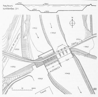
Abb. 3 Lageplan von Wehr und Krafthaus 1:5000. — Cliché «SBZ»
