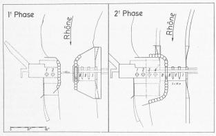
Abb. 9. Schema der Bauetappen beim Kraftwerk Verbois Clichés von Abb. 6 bis 9 aus dem «Bulletin Technique»
