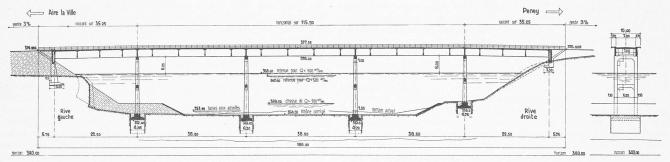
Abb. 8. Zur Ausführung gewählter Submissionsentwurf (324000 Fr.). Eisenbetonbalken über 5 Oeffnungen von Ing. Fatio (Genf). — 1:1200
