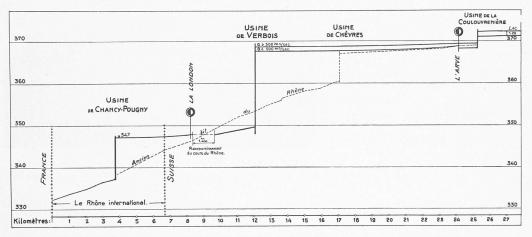
Abb. 1. Längenprofil der ausgebauten Rhone vom Genfersee bis zur Landesgrenze Längen 1:200000, Höhen 1:800. — Cliché «L'Entreprise»
