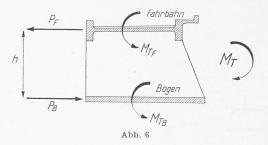
die genaue Lösung des Spannungs- und Verformungszustandes äusserst verwickelt, schwierig und sehr weitläufig. Dazu kommt noch die verschiedene Auflagerungsart von Bogen (eingespannt) und Fahrbahn (durchlaufend gestützt). In der vorliegenden Nachrechnung wurde daher versucht, unter vereinfachten Annahmen den Anteil der Torsion zu erfassen.
