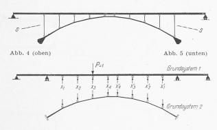
Säulen von geringem Einfluss und führt nur bei den kurzen Wänden, in der Scheitelpartie, zu Unterschieden gegenüber dem wirklichen Verhalten. Das Tragsystem für die statische Nachrechnung (Abb. 4 und 5) wird dadurch äusserlich 5 fach und innerlich 8 fach statisch unbestimmt. Eine weitere Vereinfachung würde darin bestehen, die Gelenke im Bogen selbst anzunehmen. Im Bogen würden dann keine Biegemomente auftreten, was der Wirklichkeit — wie die Messung zeigt — nicht entsprechen würde.
