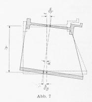
Der Einfluss der den waagrechten Verformungen zugeordneten lotrechten Durchbiegungen wurde aus den jeweiligen Biegelinien unter Beachtung der Beziehung  $M=\frac{E\,J}{\varrho}$  berücksichtigt.
