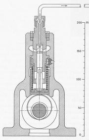
Abb. 2. Brennstoffpumpe und Akkumulier-Einspritzventil. — 1:3
