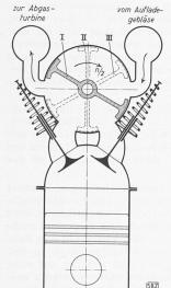
Abb. 5. Schema zur Drehschieber-Vorsteuerung des pat. Benzin-Einspritzmotors von G. Eichelberg
