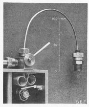
Abb. 3. Miniatur-Einspritzorgane zum Ausprobieren des Akkumuliersystems für Benzineinspritzung
