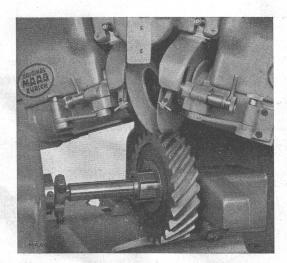
Zahnflankenschleifen eines Schraubenrades auf Maag-Zahnradschleifmaschine Type HSS-30
