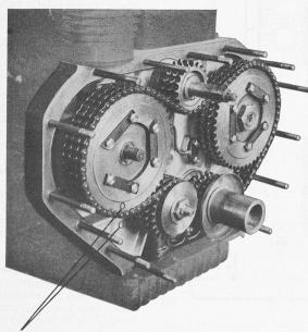
Abb. 2. Steuerungsantrieb des F. B. W.-Dieselmotors
