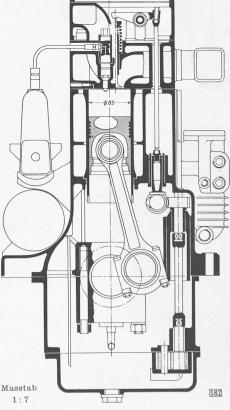
Abb. 6. Hürlimann-Saurer-Diesel,  $n=2500~\mathrm{U/min}$   $N_e=12,5~\mathrm{PSe/Zyl}$ , im Traktor-Dauerbetrieb 10,5~\mathrm{PSe}
