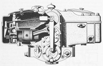
Abb. 3. M. A. G.-Victor-Typ, n = 2000 Uml/min, Ne = 12 PSe. -1:8
