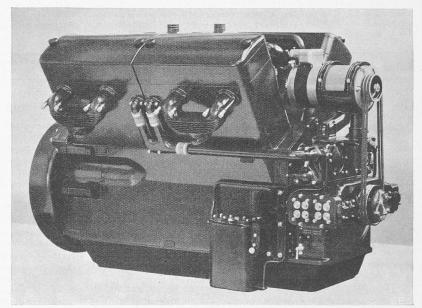
Abb. 7. Zwölfzylinder V Saurer-Dieselmotor, n=1500 U/min, Ne=\$60 PSe
