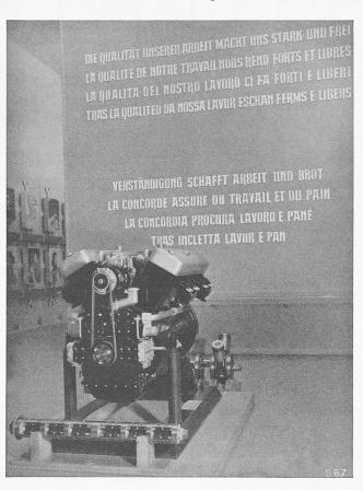
Abb. 8. Zwölfzylinder-Saurerdiesel-Flugzeugmotor für 360 PSe am Eingang in die Halle der Spitzenleistungen an der LA
