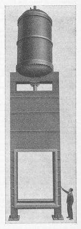
Abb. 17. Gleitschütze  $1.80 \times 2.40$  m am Lungernsee mit ferngesteuertem hydraulischem Servomotor A. G. Th. Bell & Cie., Kriens
