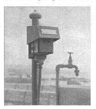
No. JA-2612. Fig. 1. Im Freien aufgestelltes Wärmeverlustmessgerät f. d. selbstätige Heizungsregulierung im Gurkenhaus der LA (Landis & Gyr).
