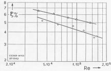
Abb. 4. Gemessene Schaufelverluste bei zwei verschiedenen Rauhigkeiten nach Reynolds'schen Zahlen geordnet
