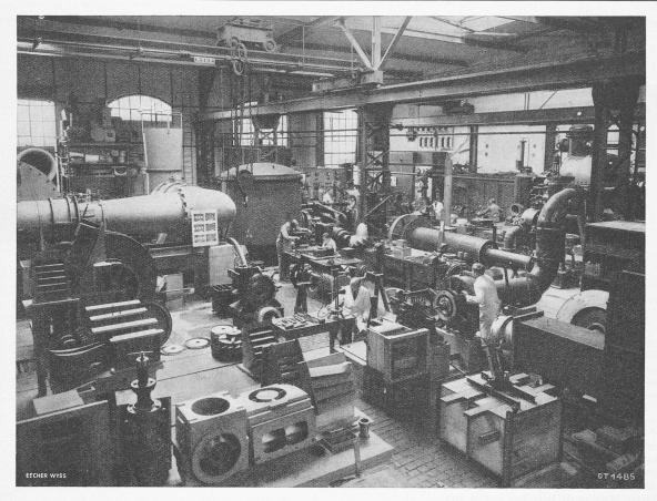
Abb. 1. Aerodynamisches Fabriklaboratorium zur Strömungsforschung an Modellen der Einzelteile von Dampfturbinen, Kompressoren, Wasserturbinen, Pumpen
