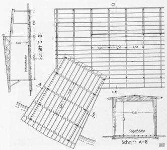
Abb. 12. Dachgebälk der Boot- und Werfthalle. — Masstab 1:400
