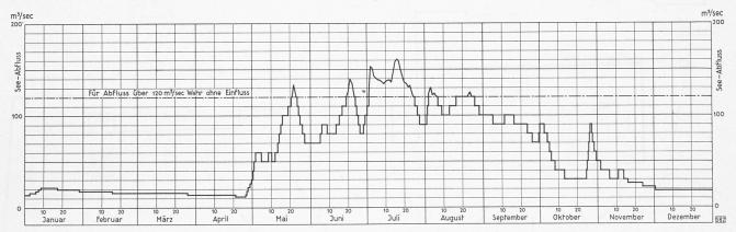
Abb. 5. Abflussmengen entsprechend Reglement mit Abflussmengenlinien (Abb. 4) und der dort eingezeichneten Seestandskurve
