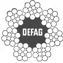
drallarme und spannungs- freie Normal-Litzen- Konstruktion
