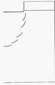
Abb. 13 Anwendung von Frey'schen Leitschaufeln zur Vermeidung des Krümmungseinflusses
