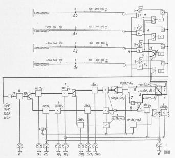
Abb. 4. Prinzipielles Schaltschema des Stereomaten
