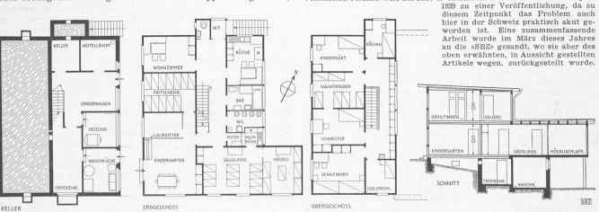
Abb. 1. Grundrisse und Schnitt der Kinderkrippe von Lindt & Sprüngli in Kilchberg bei Zürich. — Masstab 1:250
