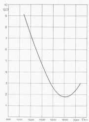
Abb. 1. Beispiel für den CO-Gehalt der Auspuffgase bei einem Benzinmotor mittlerer Leistung
