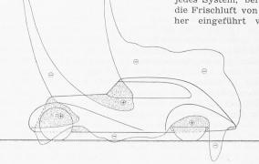
Abb. 4. Schematische Druckverteilung im Mittellängsschnitt eines fahrenden Autos üblicher Form. + Ueberdruck, — Unterdruck
