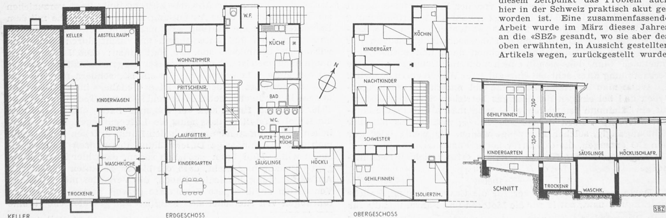
Abb. 1. Grundrisse und Schnitt der Kinderkrippe von Lindt &amp; Sprüngli in Kilchberg bei Zürich. — Masstab 1 : 250
