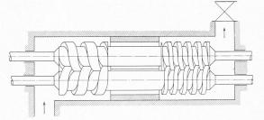
Abb. 2. Schraubenpumpe mit stufenweiser Fördermenge
