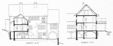
Abb. 18. Schnitte (vergl. Abb. 15). — 1:400. — Abb. 17 (unten). Untergeschoss
