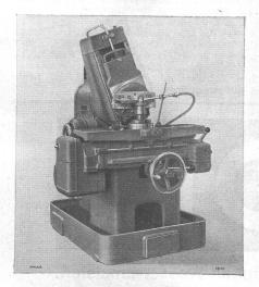
Maag-Zahnradhobelmaschine Type SH-10 (Schnelläufer) für Stirn- und Schraubenräder bis 108 mm Durchmesser. (In der L. A. im Betrieb zu sehen.)
