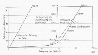
Abb. 17. Bewegung des Seilkopfes beim Spannen der Abspannseile
