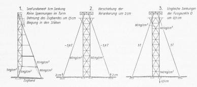
Abb. 19. Einfluss der Fundamentsenkungen auf die Beanspruchungen
