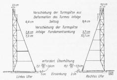
Abb. 20. Ueberhöhung des Strebenfusses bei der Montage
