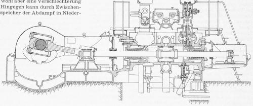
Abb. 2. DEMAG-Umkehrdampfmaschine mit ölhydraul. Steuerung, Schnitt etwa 1:75; nach «Stahl und Eisen»
