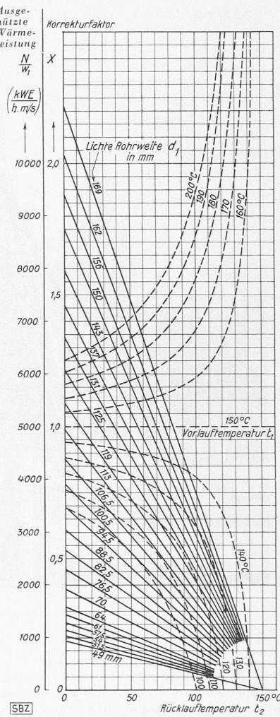
Abb. 1 (rechts). Ausgenützte Wärmeleistung bei verschiedenen Rohrweiten (ausgezogen) und Korrekturfaktor bei verschiedenen Vorlauftemperaturen (gestrichelt) in Funktion der Rücklauftemperatur
