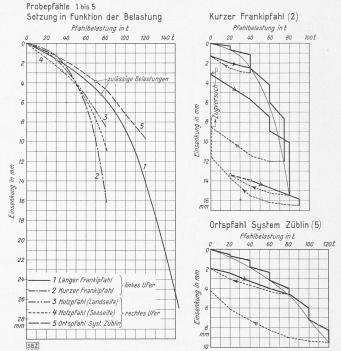
Abb. 5. Ergebnisse der Probebelastungen auf Druck
