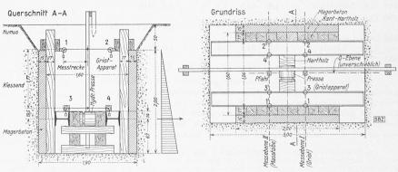
Abb. 7a. Ermittlung der horizontalen Nachgiebigkeit des Bodens. Versuchs-Anordnung 1:60
